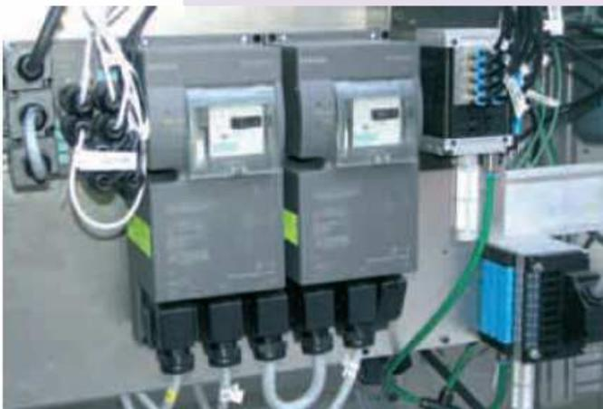
Ilot ET 200X avec deux départs-moteurs et un bloc d'électrovanne pneumatique, au poste 6 de chargement
