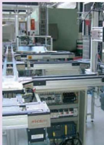
Au poste 4, l'automate de sécurité SIMATIC S7-300 avec sa CPU 315F et la station de périphérie décentralisée ET 200 avec CPU de sécurité intégrée.
